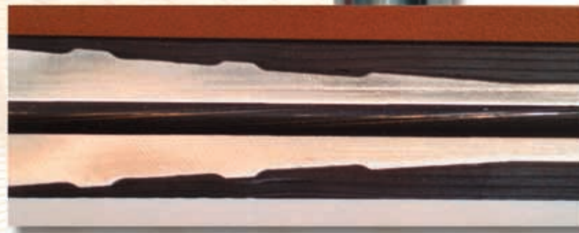
Schnitt durch einen Carbon-Lauf von Christensen Arms. Das Geschoss wird in einem schwingungsoptimierten, nach vorne sehr dünnwandigen Stahl Lauf geführt. Für hohe Steife ist er mit Kohlefasern und Epoxy umhüllt: Die aufwendigste Art, Stabilität bei geringem Gewicht zu erreichen.
