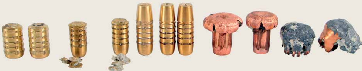
Möller MJG, Lapua Naturalis ja Norma Oryx kaliipereissa .30 ja 9,3 mm. MJG on luotettavimmillaan silloin kun osumanopeus on reilusti suurempi kuin 800 m/s. Kun sirpaloitumista ei enää tapahdu, luoti toimii kuten täysvaippa.
